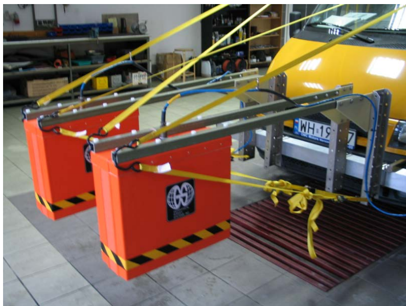
Rysunek. Przykład dwu-antenowego zestawu GPR do badań drogowych (anten: 1 GHz i 2,2 GHz)
