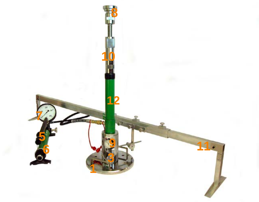
Rys. 1.2 Aparatura VSS z jednopunktowym pomiarem przemieszczenia płyty
