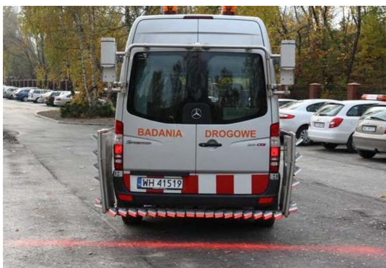
Rysunek. Zestaw oświetlaczy LED i kamer do robienia zdjęć nawierzchni
