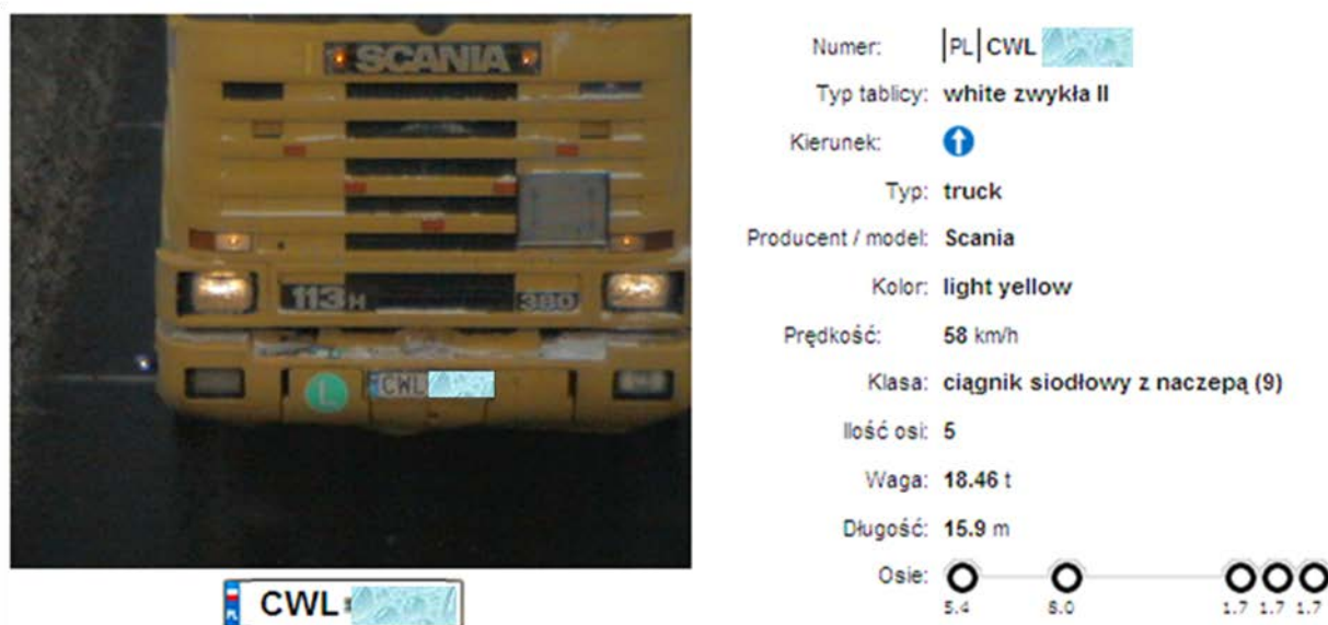
Rysunek 5.2 Przykład wizualizacji wyników ważenia i identyfikacji pojazdu w ruchu
