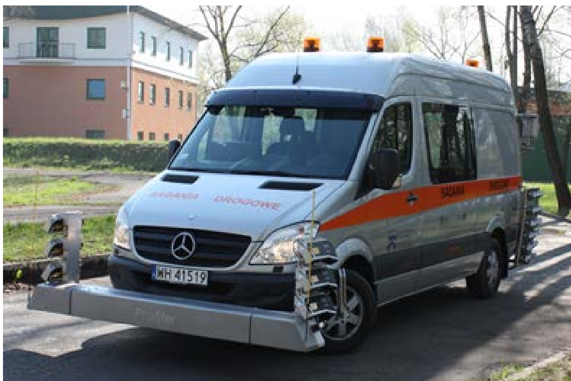
Rysunek. Profilograf laserowy SPDE użytkowany przez IBDiM
