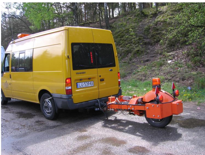
Rysunek. Zestaw SRT-3 do pomiaru współczynnika tarcia nawierzchni drogowych
