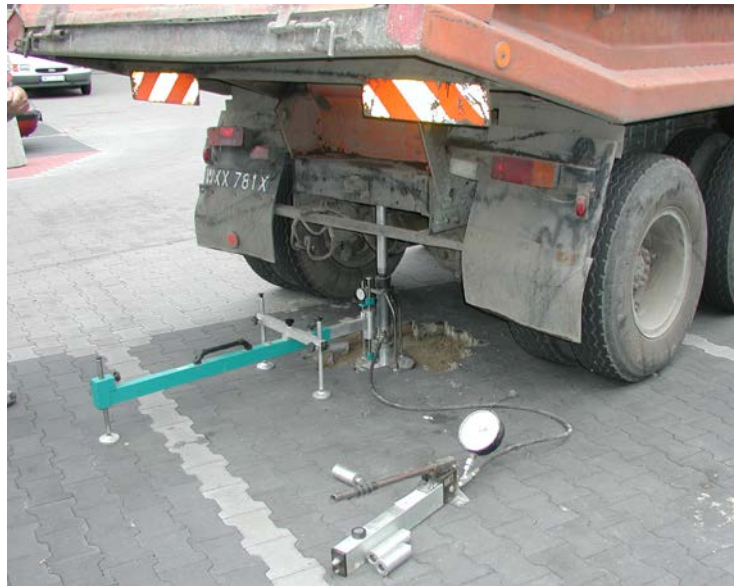
Rys. 1.3 Aparatura VSS przygotowana do badania
